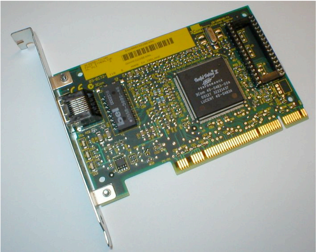
Fig. 2.2.1 La scheda di rete si occupa dell'interfacciamento del computer alla LAN. Una volta installata nel PC la scheda, si dispone di una presa di a cui connettere il cavo di rete
